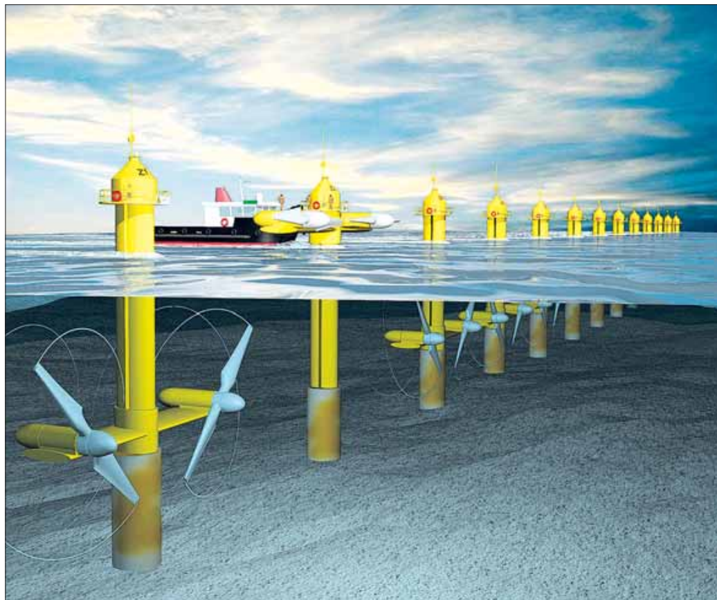
Windmühlen unter Wasser: Parks von Doppelrotoren, so hoffen die Entwickler von Seaflow, sollen bald vor europäischen Küsten Strom erzeugen. Schaubild: MCT
